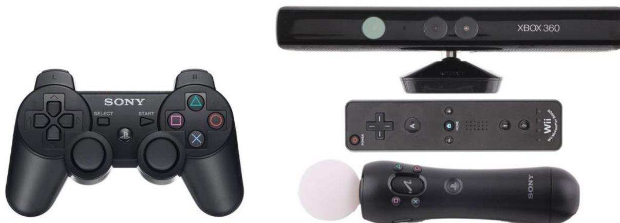
Figura 1: A esquerda um *joystick* convencional, a direita controladores que leem os movimentos corporais do jogador (de cima pra baixo: kinect, wiiremote e Sony Move).
